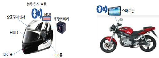
그림 1. 스마트헬멧 연동 오토바이 시스템 구조 Fig. 1. Autobike System Architecture Interlocking Smart-helmet
