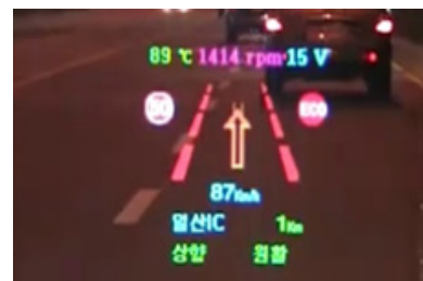
그림 7. 차량용 HUD 표시 예 Fig. 7. Example of Car HUD Display
