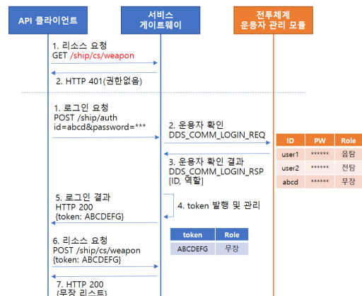
그림 4. 인증토큰을 이용한 API 요청 절차 Fig. 4. Procedure of API Request Calls with Authentication Token
