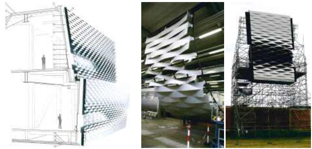
<그림 14> Messe Basel 파사드 단면과 트위스트밴드 제작 실험
