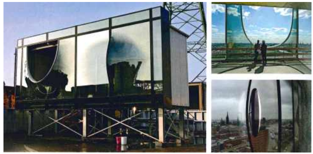
<그림 18> Elbphilharmonie의 Bent-glass 실험과 구축
