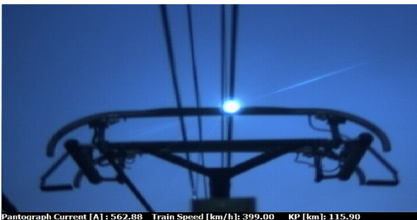
그림 5 이선아크 발생 영상 Fig. 5 A photograph of arc generation by contact loss
