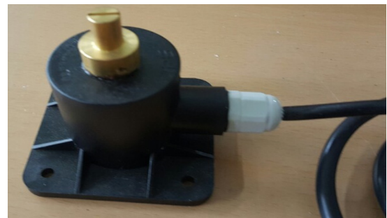
그림 2.8 최종 개발된 러더센서 Fig. 2.8 The developed rudder sensor
