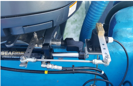
그림 3.3 선외기 선박에 장착된 러더센서 Fig. 3.3 The installed rudder sensor in outboard ship
