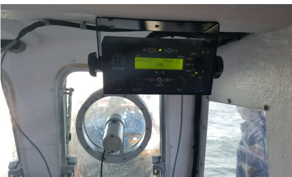
그림 3.4 러더센서의 값을 표시하는 통합컨트롤러 Fig. 3.4 Integrated controller showing rudder sensor value
