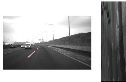
그림 8. 차선 오인식 결과 (좌:도로영상, 우:역투영영상) Fig. 8. Lane unrecognition result (Left: Road image, Right: IPM image)
