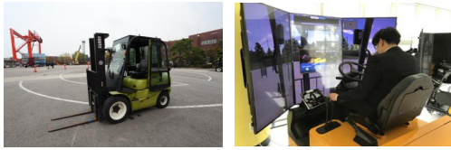
그림 7. 실제 지게차 및 기능사 실기코스 vs. 지게차운전기능사 실기 시뮬레이터
