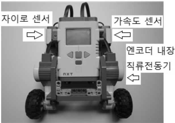
그림 1. 이륜 도립진자 로봇 Fig. 1. Two-Wheel Inverted Pendulum Robot.
