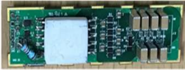
Fig. 6. High Voltage Generator image 그림 6. High Voltage Generator 이미지
