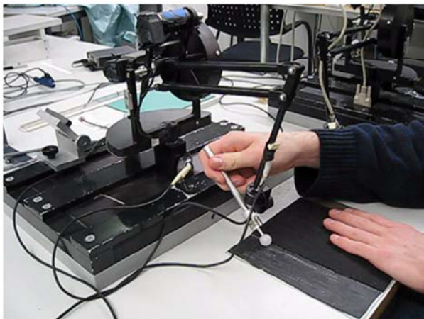
그림 2. 위는 경도 모델링의 예. Force Sensor가 달려있는 햅틱 장치로 고무공을 누르면서 Force와 Displacement 데이터를 얻고, 이를 비선형 경도 모델인 Hunt-Crossley 모델에 적용하여 파라미터를 구한 결과. 아래는 마찰력 모델링의 예. 같은 장치로 고무 표면을 긁으면서 Normal Force, Velocity, Lateral Force 데이터를 얻고, 이를 마찰 모델인 Dahl+Viscous 모델에 적용하여 파라미터를 구한 결과
