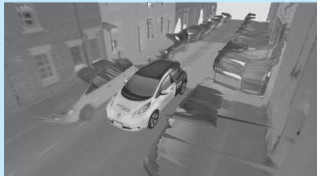
그림 3 2차원 라이다 센서를 이용한 위치추정기술(영국, 옥스퍼드 대학)
