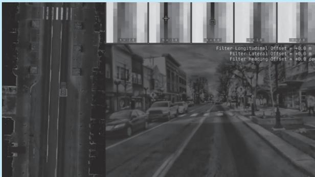
그림 2 단안 카메라 한 대를 이용한 위치추정기술(미국, 미시건 대학)
