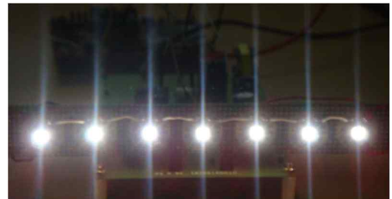
그림 24. Power LED의 40% 디밍 점등 Fig. 24. 40% Dimming lighting of power LED.
