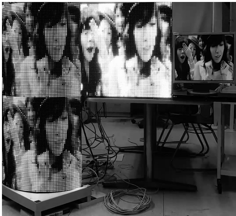
그림 12. DVD Player를 이용한 영상표출 모습 Fig 12. Image display using DVD player.
