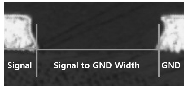
그림 3. 기판 위 제작된 전송 선로의 단면 사진
