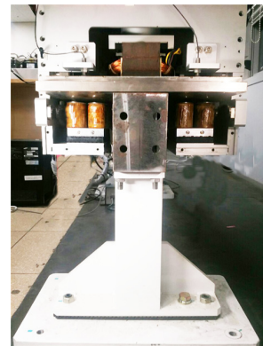
그림 2. 자기부상 물류이송시스템의 구조 사진 Fig. 2. Architecture photo of the magnetic levitated logistic transportation system
