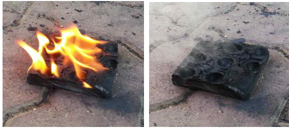
Fig. 2. Fire test of an existed carbon tile 그림 2. 기존타일 화재시험
