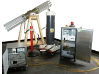
차량용(transportable) 전기장: 3.3 kV/m @ 100 m
