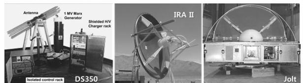
[그림 5] 광대역 파형(wideband waveforms)을 갖는 고출력 전자파 시험 시설
