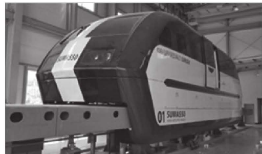
[그림 3] 저진공 튜브 공력시험장치 및 LSM 자기부상차량
