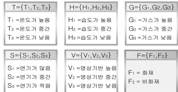
그림 4. 퍼지추론기반 화재 검출 알고리즘의 퍼지 집합(Fuzzy Set) 정의 Fig. 4. Definition of Fuzzy set of fuzzy-inference-based fire detection algorithm.
