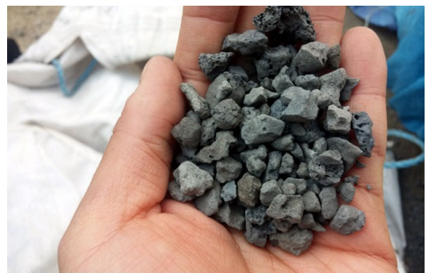
Fig. 1 10mm Steel Slag
