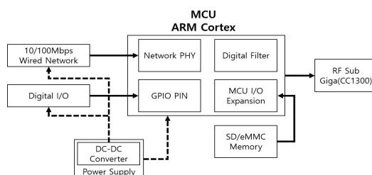
그림 4. Temporary-EMS 블록도
