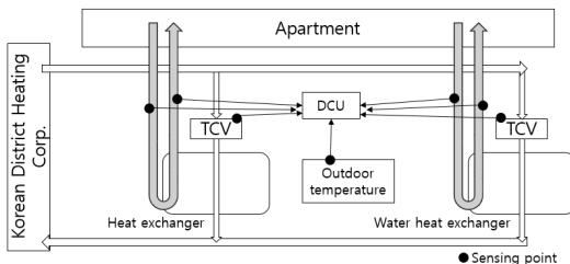
그림 1. 지역난방 2차측 열교환설비 구성도 및 측정포인트
