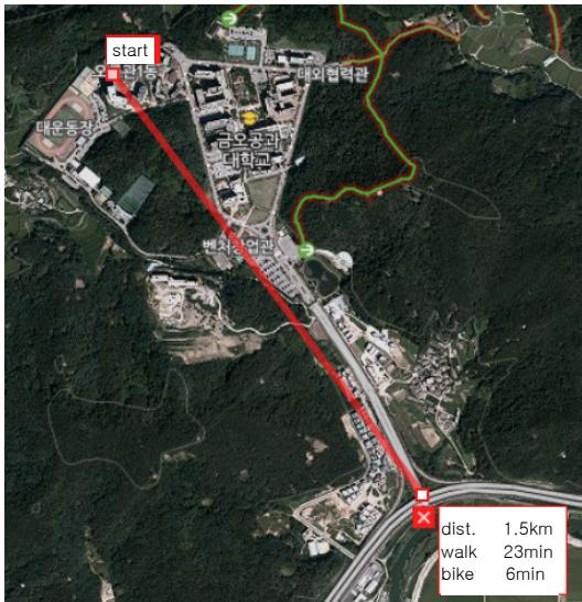
그림 10. LoRaWAN 실외 통신 거리 테스트
