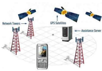
그림 3. A-GPS의 개념도 Fig. 3. Diagram of A-GPS
