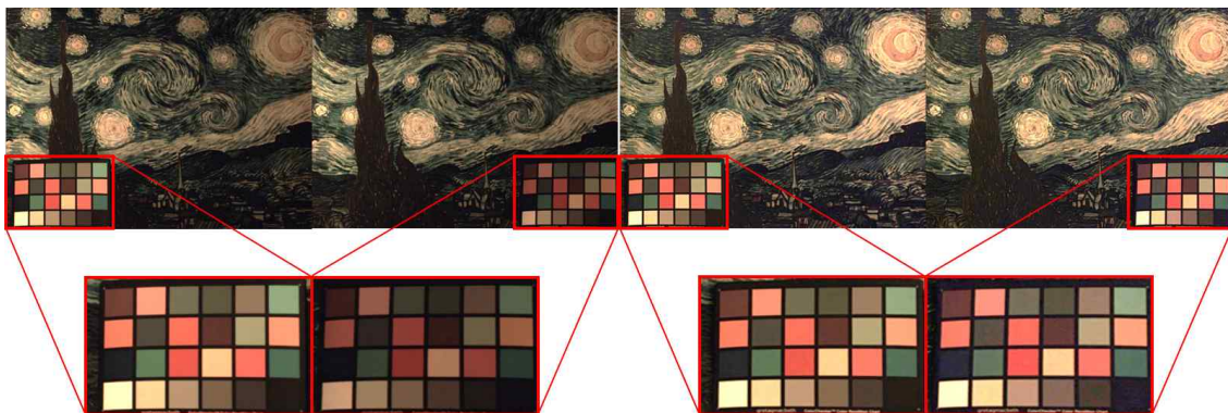
그림 6. 색상 보정 전 컬러체커 비교(좌)와 색상 보정 후 컬러체커 비교(우) Fig. 6. Comparison of color checker before color correction(left) and comparison of color checker after color correction(right)
