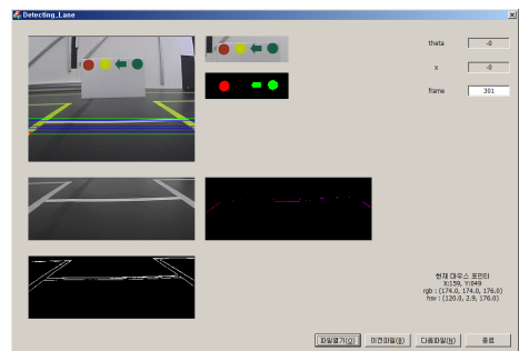
그림 9. 색상 정보를 이용한 신호등 구분 Fig. 9 Traffic light classification using color information
