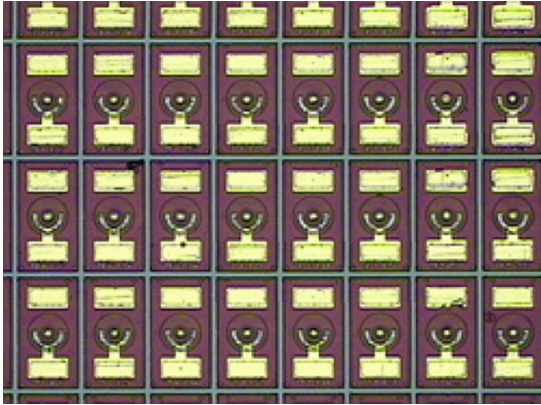
그림 3. 10G 장파장 VCSEL chip 및 10Gbps eye pattern
