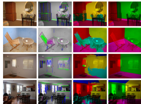
(그림 11) 내벽구조 검출 이미지 (실패) (Figure 11) Inside wall frame detected images (failed)
