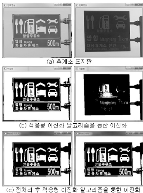
그림 8. 고속도로 휴게소 표지판의 이진화 결과 Fig. 8. Results of binarization of service area traffic sign.
