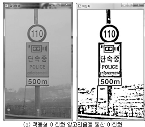
그림 7. 고속도로 상의 속도제한 표지판의 이진화 결과 Fig. 7. Results of binarization of speed limit traffic sign.
