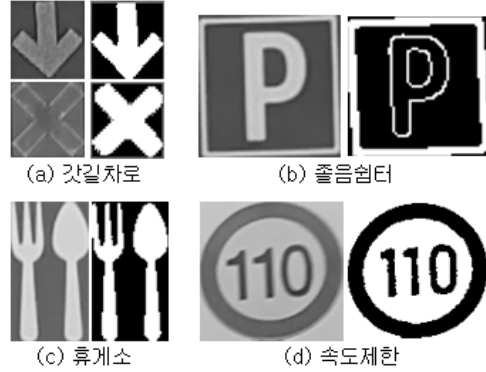
그림 3. 다양한 교통 표지판의 특징과 이진화된 영상 Fig. 3. Various features & binarized images of traffic signs.
