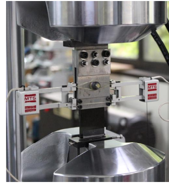
Fig. 2. ASTM D5961 Proc. A test
