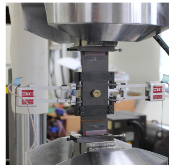
Fig. 3. ASTM D5961 Proc. B test
