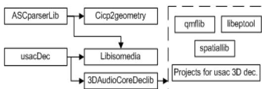
그림 2. ASCparserLib와 usacDec 프로젝트 종속성 구조
