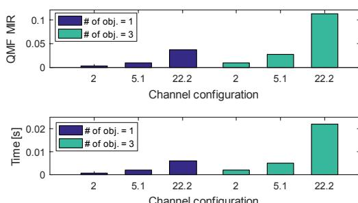
그림 11. 시간 영역 객체 렌더러 연산량 (위, 단위: QMF\_MIR) 및 연산 소요 시간 (아래, 단위: 초)
