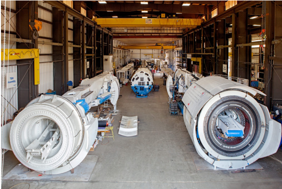
〈그림 4〉 TBM 재제작/재보수 과정
