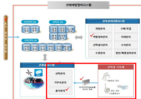
그림 1. 선박예방정비시스템 Fig. 1 Ship planned maintenance system
