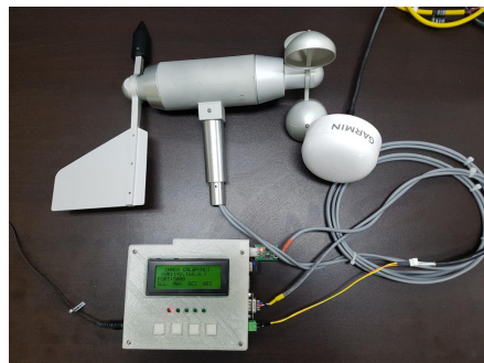
그림 17. NMEA0183/2000 게이트웨이와 센서 Fig. 17 NMEA0183/2000 gateway with sensors
