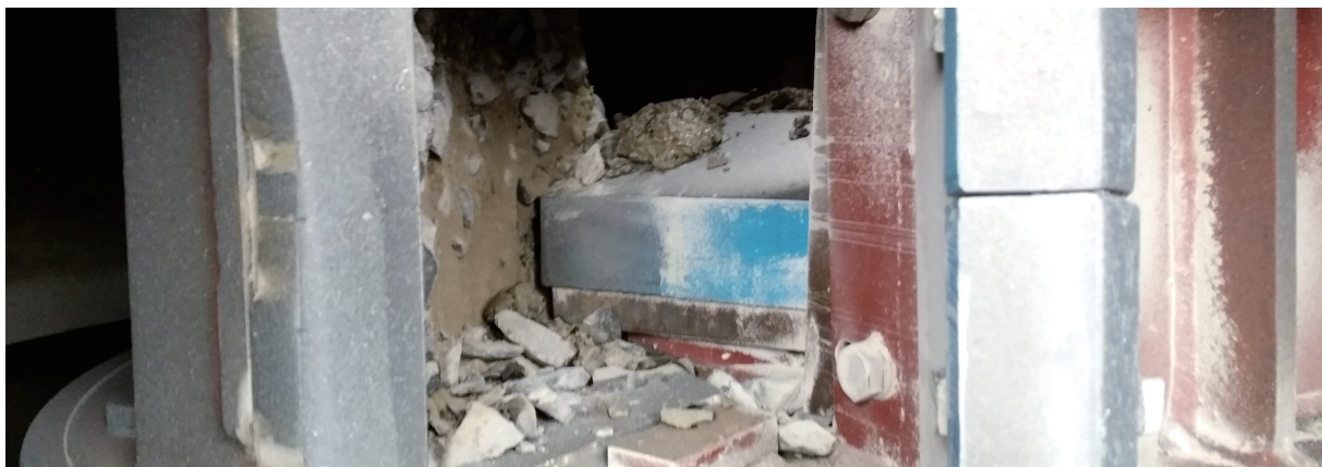
사진 3. Build up 현상에 의해 골재가 로터 내부에 코팅된 상태
