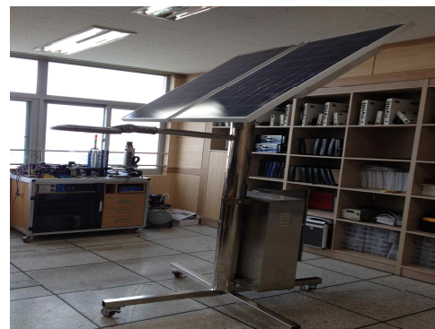
Fig. 6. Developed LED Security Light System 그림 6. 개발된 LED 보안등 시스템
