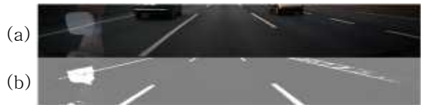
Fig. 3. (a) ROI for lane detection (b) Lane detection result 그림 3. (a) 차선 검출을 위한 ROI (b) 차선 검출 결과
