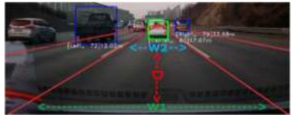
Fig. 7. Distance & TTC calculation result 그림 7. 거리 및 TTC 계산 결과
