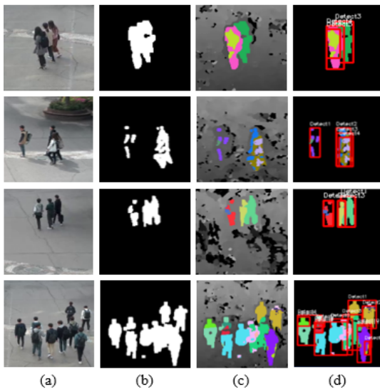
(그림 2) RGB-D 정보를 이용한 객체 탐지 결과 (Figure 2) Object Detection Result using RGB-D information
