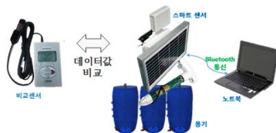
그림 6. 함수비 센서의 설치 블록도
