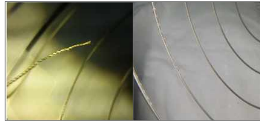
<그림 9> 최종 개발한 니크롬선 히터(좌)와 니크롬선+피복(우)
