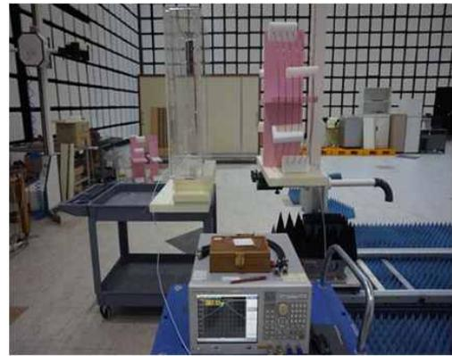
그림 12. 송신부 헬리컬 및 수신부 스파이럴 코일을 이용한 무선전력전송시스템 측정
