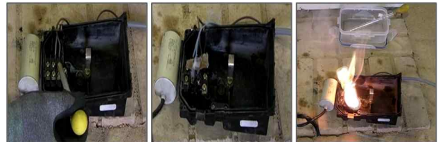
그림 14 커패시터 샘플 B에서 유출된 내부 물질의 착화 시험[2] Fig. 14 Ignition test of internal material from capacitor sample B[2]
