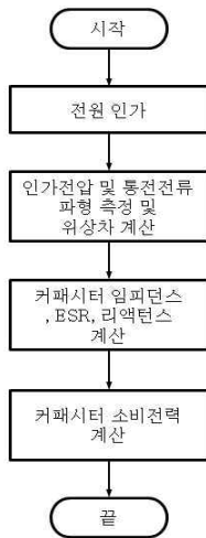
그림 10 실험 순서도 2 - 커패시터 임피던스 측정 Fig. 10 Experiment flow chart 2 - measurement of capacitor impedance
