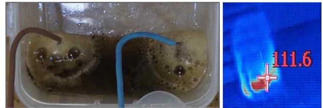
그림 13 커패시터 샘플 B에서 유출된 내부 물질의 통전 시험[2] Fig. 13 Current carrying test of internal material from capacitor sample B[2]
