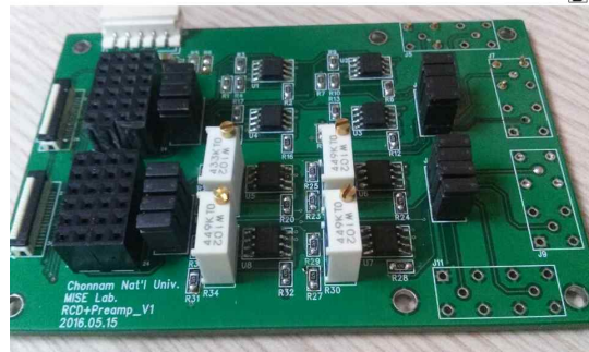
그림 6 저잡음 반전 전치 증폭기 설계도(상) 및 제작 사진(하)
