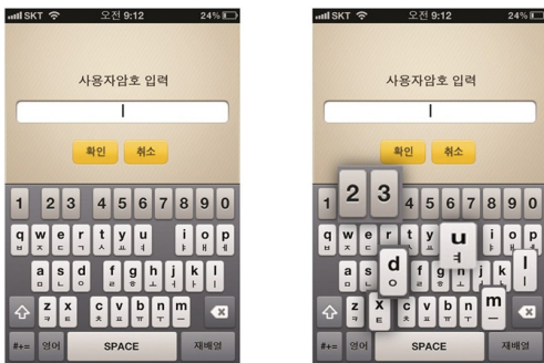
그림 7. 초기 상태와 사용자 적응 이후 키 배열 비교 Fig. 7 Comparison of initial state and key array after user adaptation training
