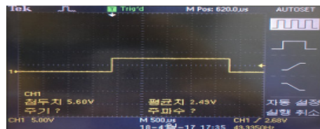
c) 각 180° 때 펄스 파형 c) Pulse waveform at 180° degree
