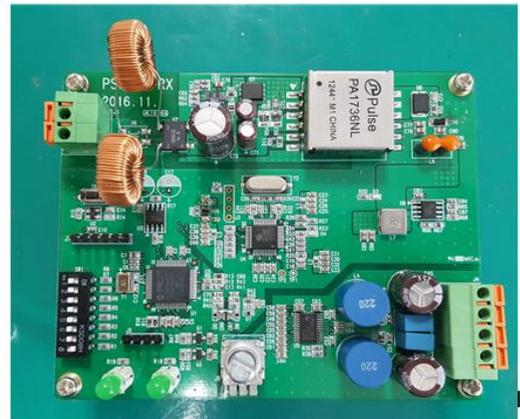
그림 4. PLC 스피커 PCB
