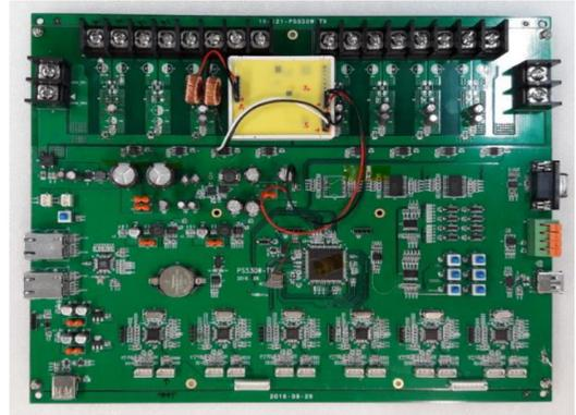
그림 3. PLC PA 제어기 PCB
