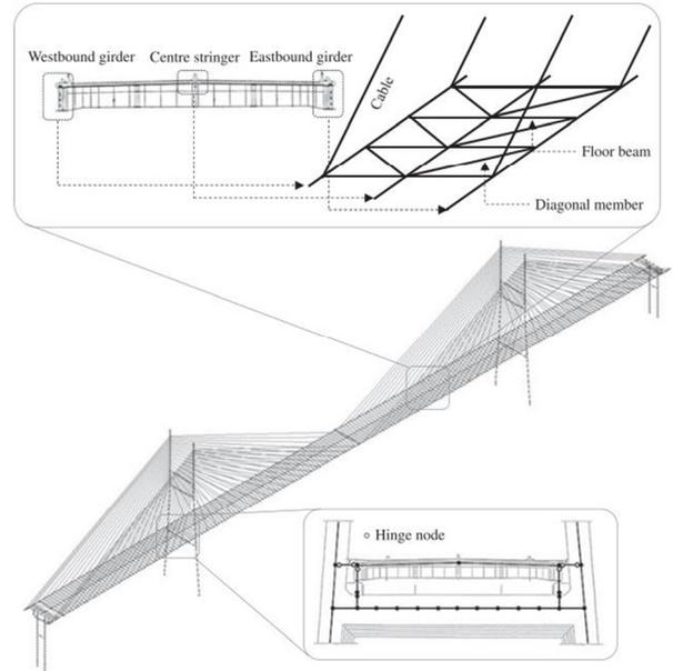
그림 1 Finite element model of Seohae Grand Bridge (Park, Park et al. 2015)
