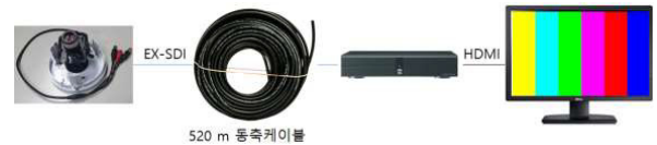
그림 12 영상 전송거리 시험구성도 Fig. 12 The test diagram of video transmit distance
