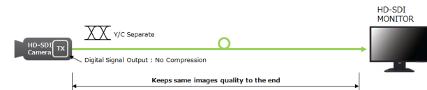
그림 1 HD-SDI 전송방식의 개념도 Fig. 1 The concept diagram of HD-SDI transmit method
