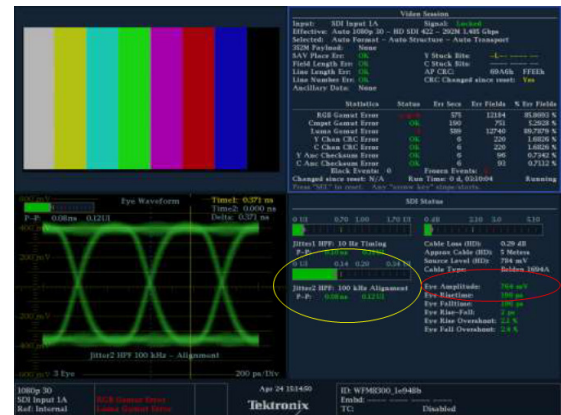
그림 11 Jitter와 Eye Pattern Amplitude 시험결과 화면 Fig. 11 Jitter와 Eye Pattern Amplitude test result
