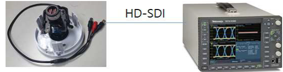
그림 10 Jitter와 Eye Pattern Amplitude 시험구성도 Fig. 10 The test diagram of Jitter and Eye Pattern
