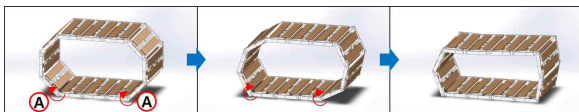
그림 1. 형상기억합금 액추에이터 응용: 롤링 로봇 Fig. 1. Application of SMA actuators: rolling robot
