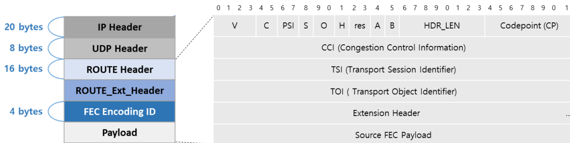
그림 4. ROUTE 패킷의 구조 Fig 4. Structure of ROUTE packet
