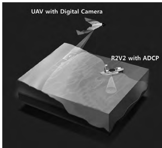
그림 10. 3차원 하천지형정보 측정 시스템
