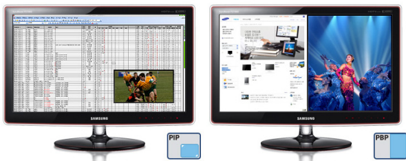
그림 12. HDMI를 통한 PIP와 PBP 형태의 미디어 영상표출 설정
